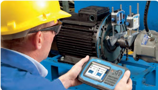
Das drahtlose Laser-Wellenausrichtsystem mit integrierter Ausrichthilfe.
