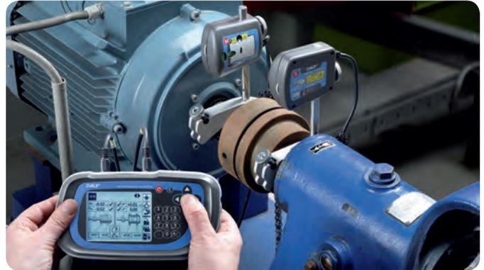
Das lasergestützte Wellenausrichtsystem mit Speicher- und Sharing-Funktionen.
