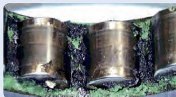
Verschmutzter Schmierstoff durch Funkerosion
