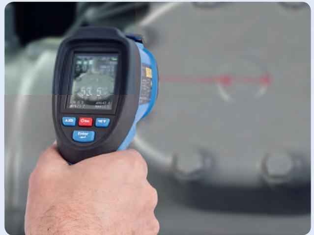
Im Fernmessmodus misst das Thermometer die abgestrahlte Wärmeenergie mit einem Infrarotsensor, der auf das Zielobjekt gerichtet wird. Das Sensorsignal wird von einem Mikroprozessor ausgewertet und als Messwert auf dem hintergrundbeleuchteten Display angezeigt. Hält der Anwender den Auslöser gedrückt, wird die Objekttemperatur vom Infrarotdetektor kontinuierlich gemessen. Dadurch sind schnelle und präzise Echtzeitmessungen möglich.
