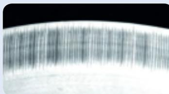
Typische Riffelung bei Funkerosion in Wälzlagern
