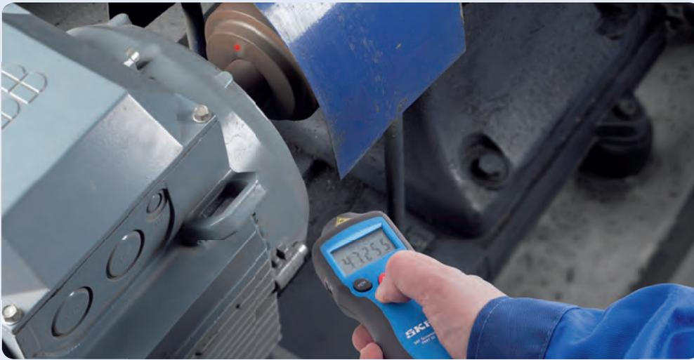
Lasersystem für einfache und sichere Fernmessungen an rotierenden Maschinen
