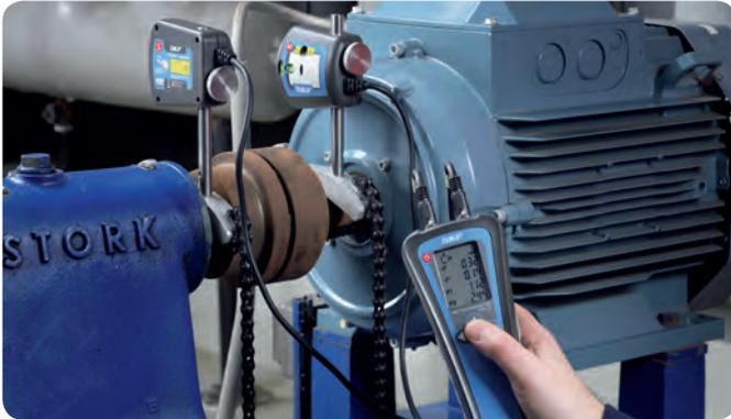
Das schnelle, einfache und kostengünstige System für die laserunterstützte Wellenausrichtung.
