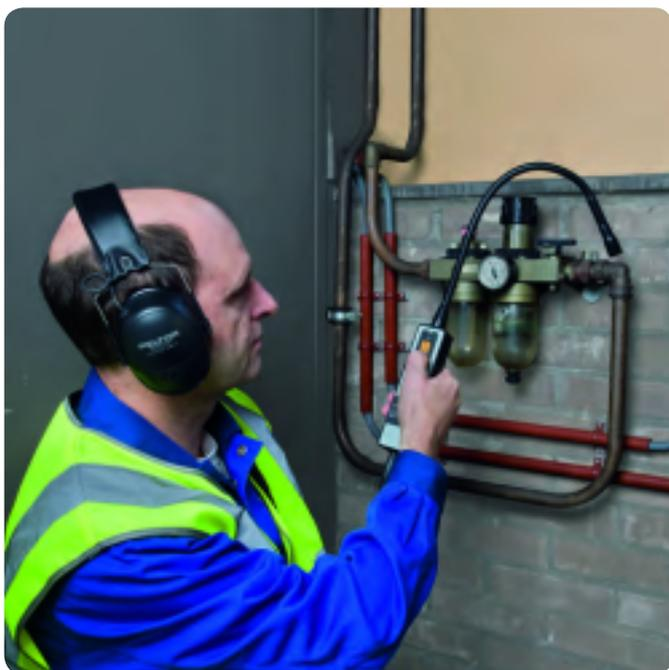
Zum Lieferumfang des TMSU 1 gehören ein Ultraschall Detektor, ein Kopfhörer, eine Gummidüse, Batterien sowie ein robuster Werkzeugkoffer.
