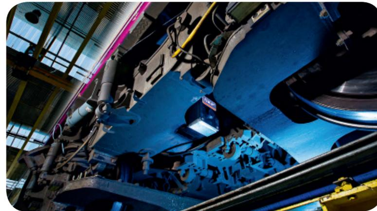
Eine der SKF Innovationen auf der Hannover Messe ist das Multilog Online-System IMx-B, das erste kabellose Komplett-drehgestell-Überwachungssystem für alle Arten von Lokomotiven und Schienenfahrzeugen für den Personenverkehr.
