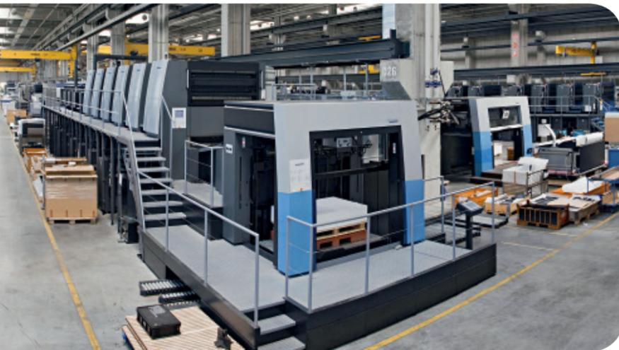
Grundfarben genau so auf den Papierbogen, dass durch deren „Mischung“ am Ende ein gestochen scharfes Bild mit natürlichen Farben entsteht. Dabei sind sogar aerodynamische Aspekte zu
